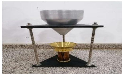
Fig. 5. FAA apparatus test
